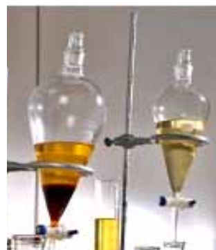
Figura 12. Comparación del aspecto de la fase de glicerina (fase inferior del decantador), del biodiesel obtenido mediante un proceso químico (izquierda) y uno enzimático (derecha).
